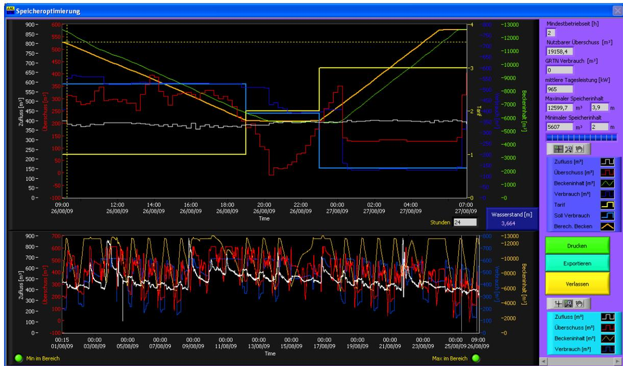
Nach Optimierungsberechnung werden die Solldurchflussdaten an die SPS übertragen.
